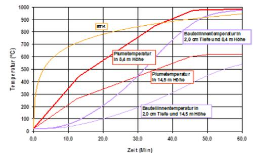
Berechnete Erwärmung von 4 cm dickem Stahlblech (Blechmitte) durch beidseitige Beaufschlagung mit Flammen- und Plumetemperaturen - beim Sz Konsumermesse in 8,4 m und 14,5 m Höhe über dem Brandherd
