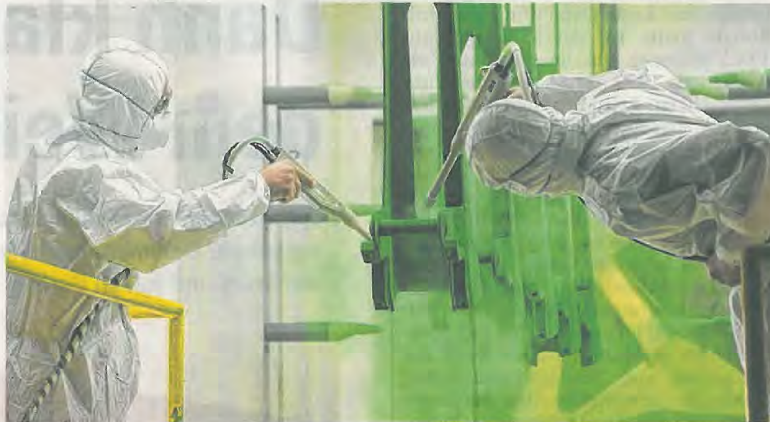
Zwei Mitarbeiter der Leipziger Firma Bodenbearbeitungsgeräte sprühen in der neuen Beschichtungsanlage Pulver auf Landmaschinenteile. Foto: Christian Nitsche
